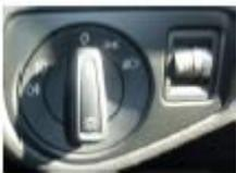
Rechts neben dem Drehknopf für die Lichtstufen kann man das Abblendlicht verstellen (zB bei schwerer Beladung im Kofferraum)
